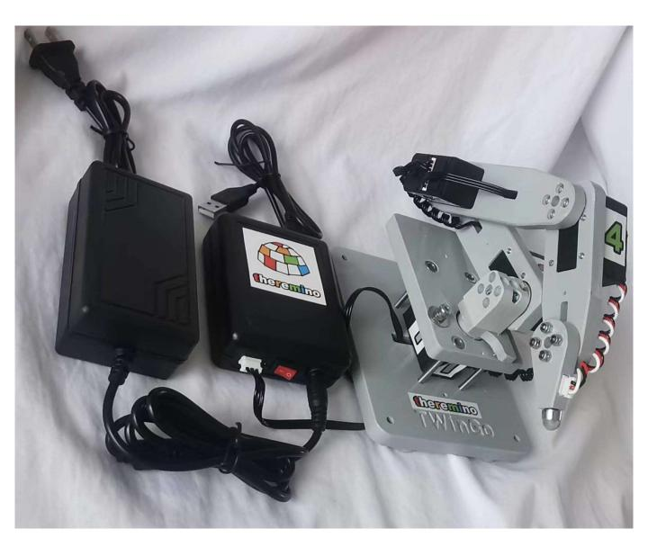
电源 电源/USB适配器 TWinGo BASIC 机械臂
