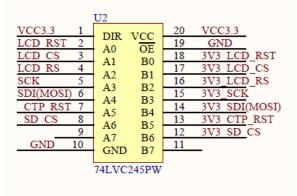
控制信号电平转换电路
